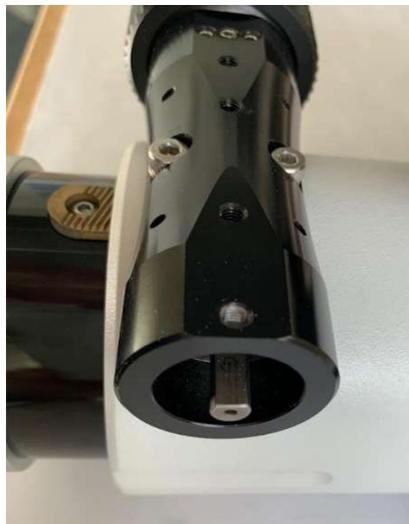
Prenez l'accouplement approprié de l'ensemble EAF et placez-le sur l'arbre de manière à ce qu'une vis sans tête se trouve sur le côté aplati. Serrez-le à travers le trou de forage, tournez le raccord de 90 ° et serrez également la deuxième vis sans tête.
